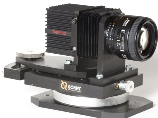
Камера на координатном устройстве для StereoPIV
