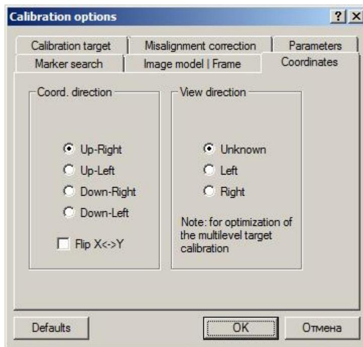
Рис. 2-47 Направление осей координат **X-Y** в системе координат эксперимента для вычисления калибровки камеры
